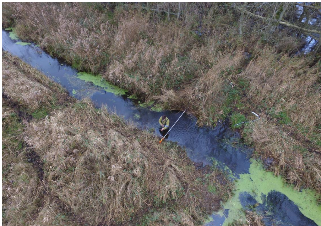
Foto 2. Kåtbæk. Måling af Q. Foto taget af dronen.
