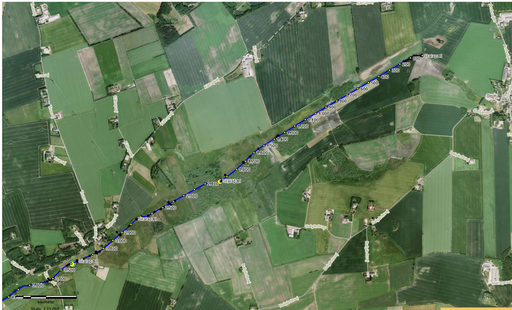
Oversigt over forsøgsstrækning Kåtbæk, som er overfløjet med drone. Stationer pr. 100m. Sorte stjerner: Målt terræn, vandspejl med GPS. Gule cirkler: målt Q og H. Lyseblå cirkel: Målestation.
