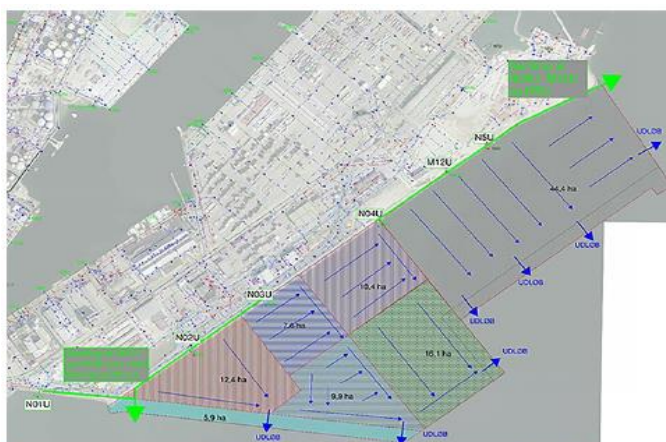
Illustration af dispositionsplan for håndtering af overfladevand på Yderhavnen. Håndtering af overfladevand fra eksisterende udløb er angivet med grønne pile. Håndtering af de nye områder på Yderhavnen er angivet med blå pile. Kilde: (Aarhus Havn, 2021).
